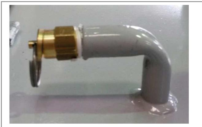
FIGURA 16: Válvula de alívio de pressão
