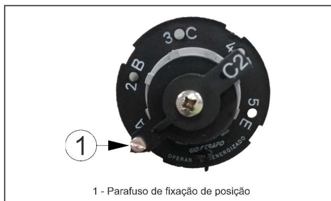
FIGURA 3: Comutador de derivação
