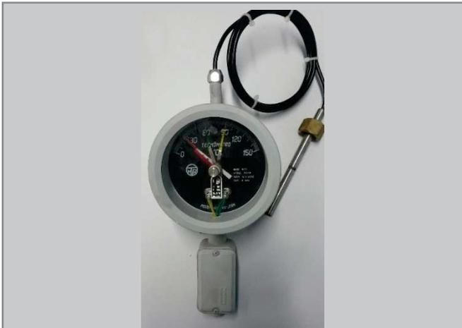
FIGURA 11: Termômetro indicador de temperatura do óleo
