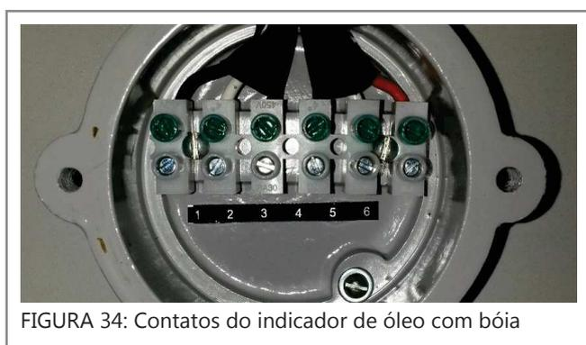
FIGURA 34: Contatos do indicador de óleo com bóia
